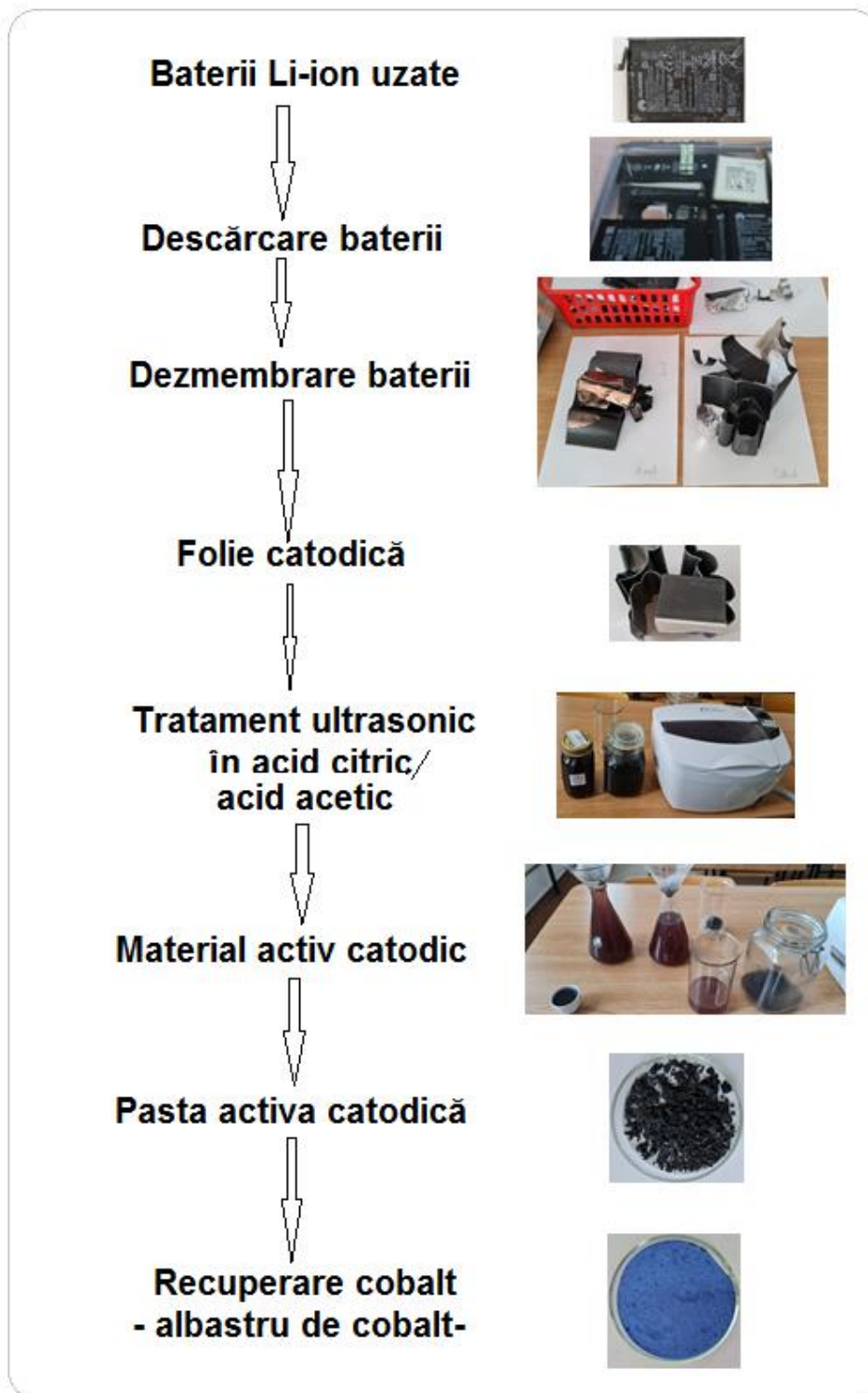
Figura 9. Schema tehnologică de recuperare a pigmentului (albastru de cobalt) din pasta catodică a bateriilor uzate Li-ion
