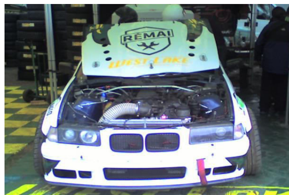
Figura 4.42. Compartiment motor - amplasament filtru de aer sport
